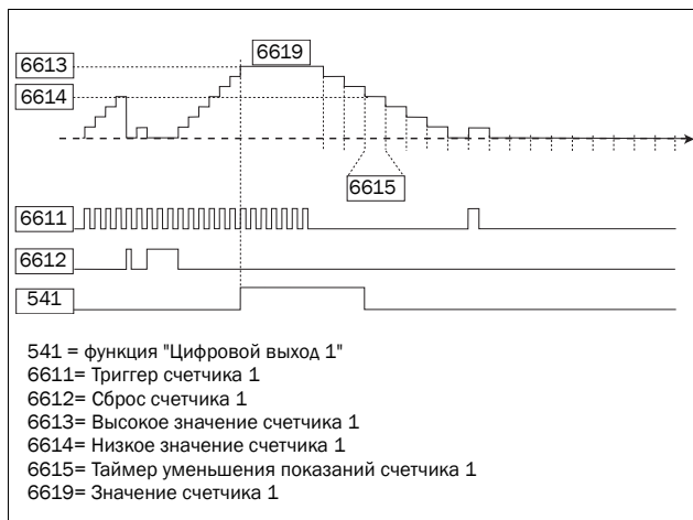
Рис. 122 Счетчики, принцип действия.
