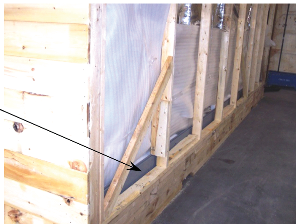
Рис. 7 – Положение подъёмных балок в экспортной таре
