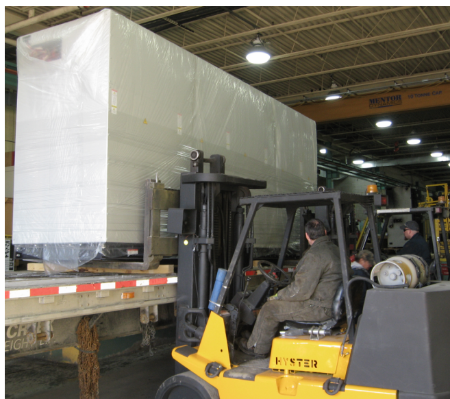
Рис. 16 – Погрузка при помощи двух погрузчиков
