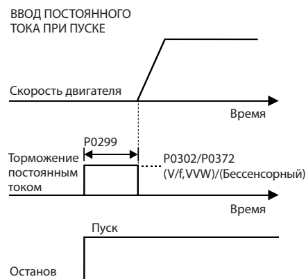
Рис. 12.10. Использование торможения постоянным током при пуске
