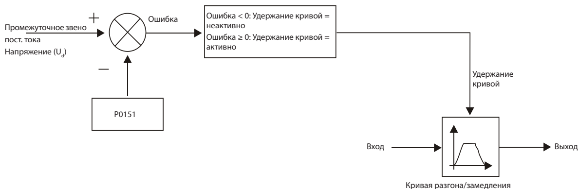
Рис. 9.10. Диаграмма ограничения напряжения промежуточного звена пост. тока с помощью функции удержания кривой
